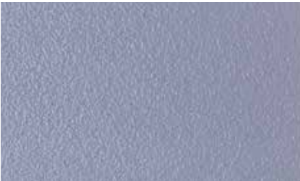
Muster 2: EP Versiegelung EP 20 rutschhemmend
