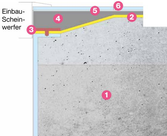
Die Abdichtung ist über die gesamte Fläche 2-lagig mit mind. 2 mm Trockenschichtstärke auszuführen. Der Einsatz von Fest-Los-Flansch ist zu bevorzugen. Die Abdichtung ist an die Flanschkonstruktionen mit unseren Abdichtungssystemen mit Murexin Gullydichtung (Größe 50x50 cm) vorzunehmen. Nach ausreichender Trocknungszeit ist eine nochmalige Probefüllung notwendig, um evtl. Fehlstellen auszuschließen zu können.
