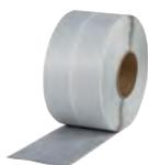
Nastro di tenuta autoadesivo realizzato con tessuto in polipropilene con rivestimento in butile, con copertura in carta siliconata sovrapposta, separata. Rivestito con gomma butilica autoadesiva altamente elastica. Componenti di sistema per l'impermeabilizzazione nella zona di pareti e pavimenti. Per copertura e sigillatura delle fughe di collegamento e angolari.
