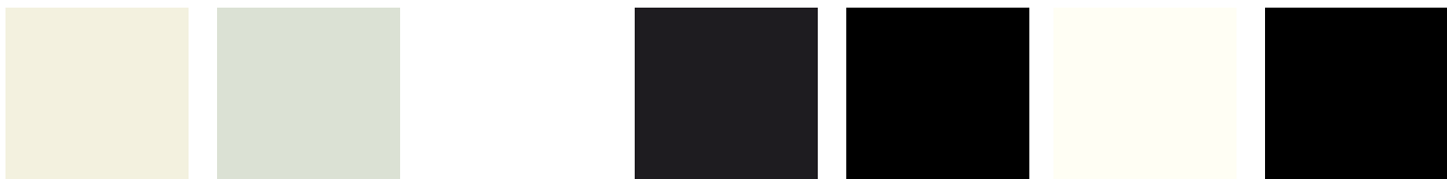
RAL 9001 IDR 76 ● RAL 9002 IDR 68 ● RAL 9003 IDR 83 ● RAL 9004 IDR 6 ● RAL 9005 IDR 4 ● RAL 9010 IDR 84 ● RAL 9011 IDR 5 ● Bianco crema ● Bianco grigiastro ● Bianco segnale ● Nero segnale ● Nero intenso ● Bianco puro ● Nero grafite ●
