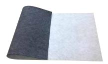
Der mehrschichtige Sandwichaufbau, in dem zu unserem Produkt eine spezielle Gummimatte integriert wurde, erzielt eine sehr hohe und sichere Trittschallminderung. Die beidseitige Vlieskaschierung lässt kein Eindringen des Klebers in die Poren der Gummimatte zu und dient somit auch zu einer sicheren Entkopplungswirkung im Kern.
