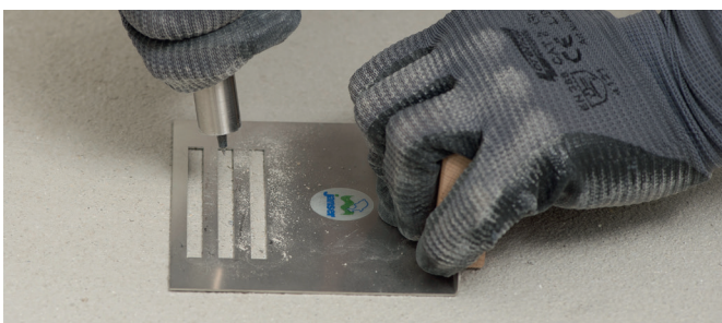
Ritzprobe per Ri-Ri-Gerät und Schablone
