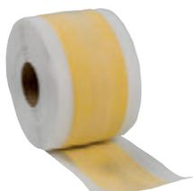
Gewebearmiertes, elastisches Dichtband mit einer gewebefreien Zone, beidseitig überstehendem Geweberand, beidseitiger Vliesbeschichtung zur optimalen Einbettung, wasserundurchlässig, chemisch beständig gegen verdünnte Säuren, Laugen und Salzlösungen. Systemkomponente zum Abdichten im Wand- und Bodenbereich, sowohl im Innen- als auch im Außenbereich. Zur Überbrückung und Abdichtung von Anschluss- und Eckfugen. Auch für Schwimmbecken geeignet.
