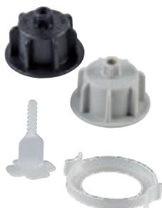
Verlegehilfe aus Kunststoff, bestehend aus der Zughaube und der Gewindelasche für Verlegegut bis zu einer Stärke von 12 mm (Verlegehilfe Zughaube BIS 12, schwarz), bzw. von 20 mm (Verlegehilfe Zughaube BIS 20, grau) - die Gewindelasche (FB 17 mit Breite 1,7 mm bzw. FB 10 mit Breite 1,0 mm) ist höhenunabhängig einsetzbar. Bei heikler Keramik oder Naturstein ist die Verwendung der transparenten Schutzunterlage SU 01 unter der entsprechenden Zughaube empfohlen.
