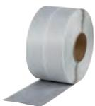
Selbstklebendes Dichtband aus butylbeschichtetem Polypropylen Vlies, mit geteilter, überlappender Silikonpapierabdeckung. Beschichtet mit hochelastischem, selbstklebendem Butylkautschuk. Systemkomponente zum Abdichten im Wand- und Bodenbereich. Zur Überbrückung und Abdichtung von Anschluss und Eckfugen.
