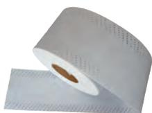
Beidseitig vlieskaschiertes und sehr elastisches Dichtband mit perforierten Randzonen zur optimalen wasserundurchlässigen Einbettung in MUREXIN Verbundabdichtungen. Systemkomponente zum Abdichten im Wand- und Bodenbereich und zur Überbrückung und Abdichtung von Anschluss- und Eckfugen.
