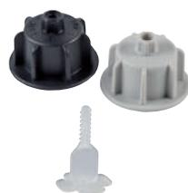
Verlegehilfe aus Kunststoff bestehend aus der Zughaube und der Gewindelasche für Verlegegut bis zu einer Stärke von 12 mm (Zughaube BIS 12, schwarz) bzw. von 20 mm (Zughaube BIS 20, grau) - die Gewindelasche ist höhenunabhängig einsetzbar. Die Verlegehilfe vereinfacht die Verlegung speziell bei Großformaten und vermindert Überzähne. Das langwierige Einrichten kann damit stark verkürzt werden und ein schnelleres Arbeiten ist möglich.
